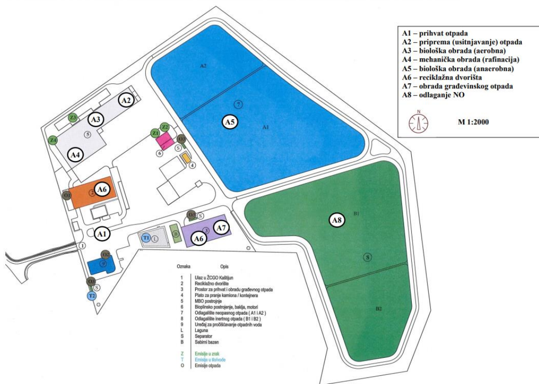
Slika 13. Nacrtni prostornog rasporeda tehnoloških procesa u Županijskom centru za gospodarenje otpadom „Kaštijun“, Izvor: Elaborat gospodarenja otpadom tvrtke Kaštijun d.o.o.
