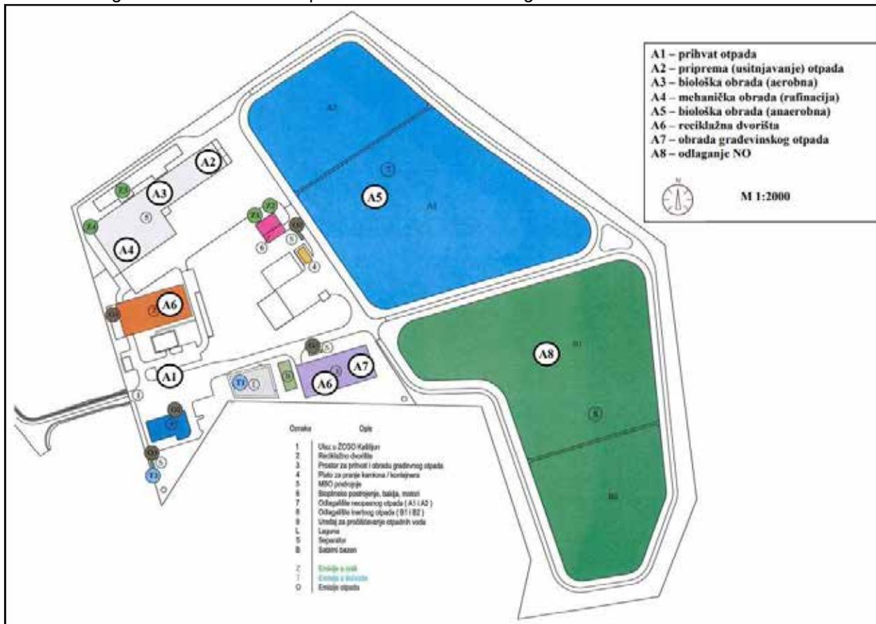
Foto 31 Disegno della collocazione spaziale delle unità tecnologiche del CRGR Castion
