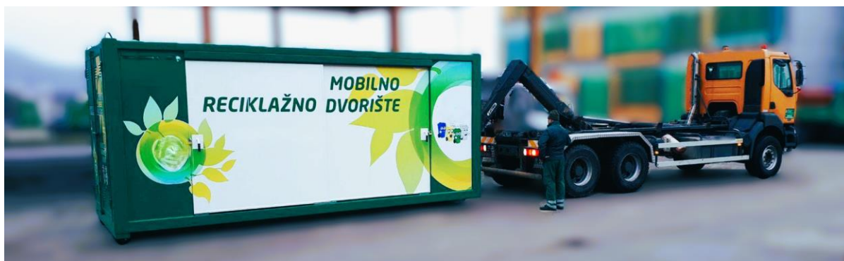
Slika 5: primjer iskrcanja mobilnog reciklažnog dvorišta na abroll sustavu
